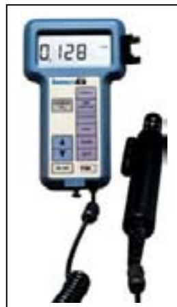
Слика 83. Уређај за испитивање CO 2 и просторији
