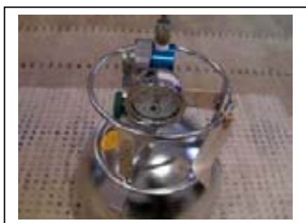
Слика 82. Уређај за снимање честица у ваздуху
