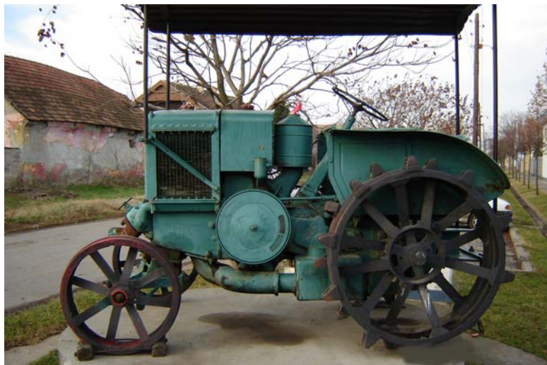
На слици трактор прототип, између локобиле и трактора
