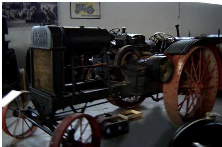
Трактор марке „hart parr“ из 1942. године, произведен у САД у фабрици „Charles City“, са снагом мотора 18 КС, гориво бензин
