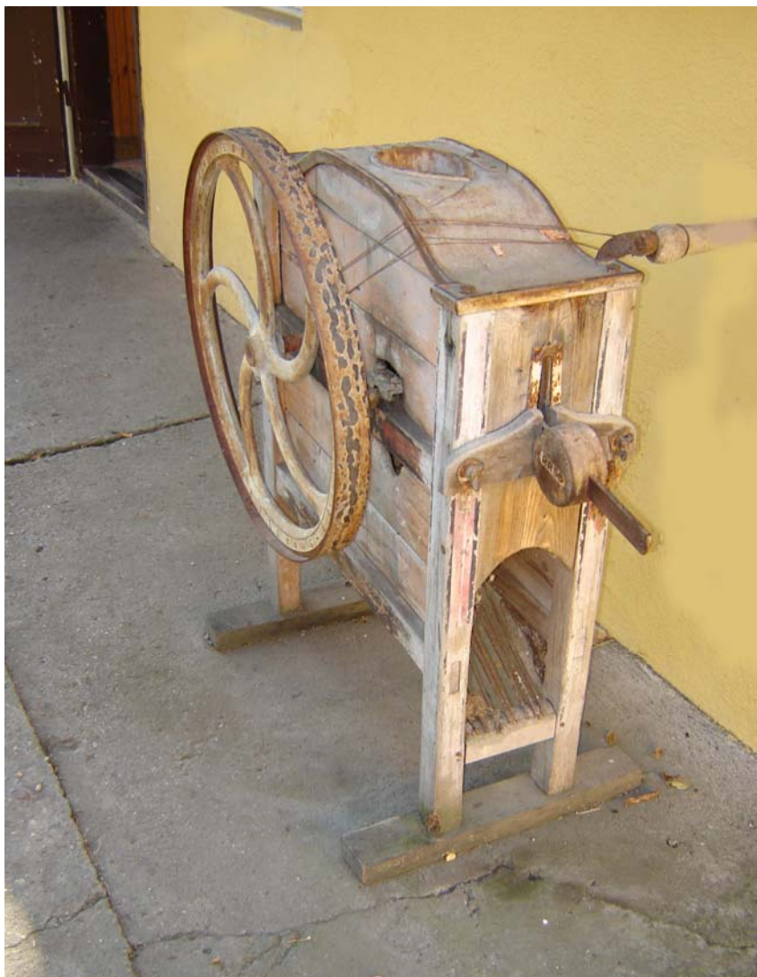
На слици је круњач за кукуруз, с краја 19. века (снимак аутора књиге, (Музеј пољопривредних машина, Кулпин, 2006)
