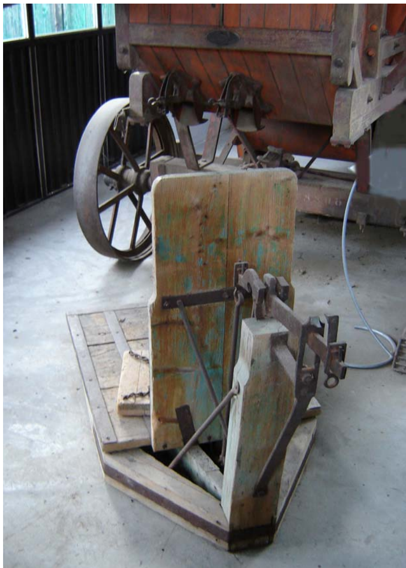
Покретна вага за мерење, из 1947. године (снимак аутора књиге)
