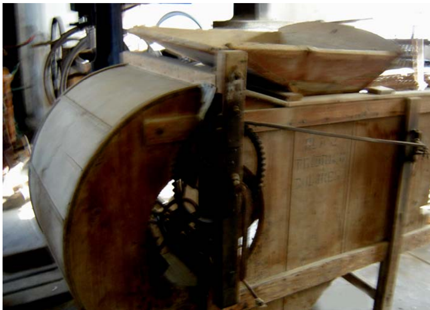
Селектор (ветрењача), за ручно провејавање семена, из 19. века
