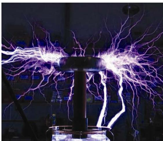
Na slici je savremeni Teslin kalem iz XXI veka. Na osnovu Teslinog izuma – izrađen je kalem na kome se koriste visokofrekventne struje sa visokom frekvencijom i visokim naponom. Ovim eksperimentom se postiže ogromna električna frekvencija i visoki potencijal energije.
