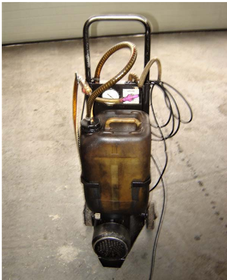
Specijalan aparat za izvlačenje lubrikanata iz motornih vozila «ford» (Snimak autora knjige, ljubaznošću vlasnika servisa «Maksim», Novi Sad, 24. 3. 2021)
