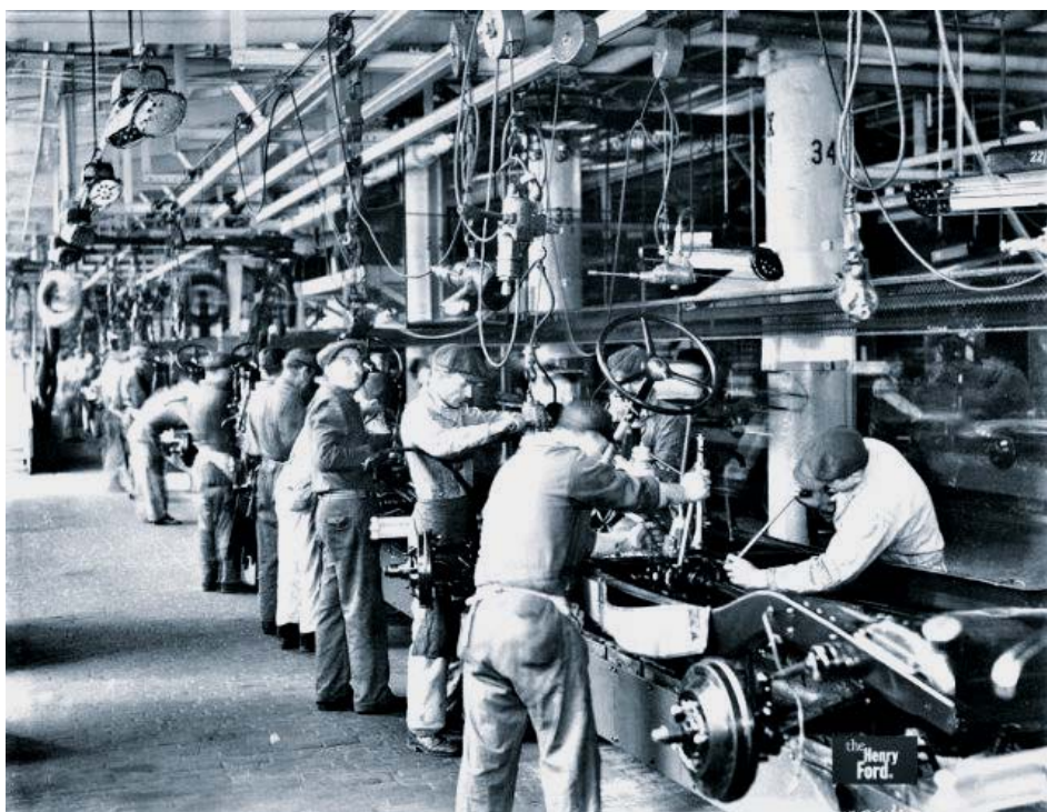
Montaža delova automobila «ford» – na pokretnoj traci (1920)
