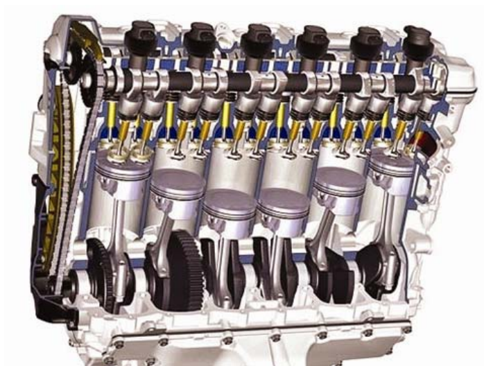
Redni motor sa šest cilindara (slike 1-2)
